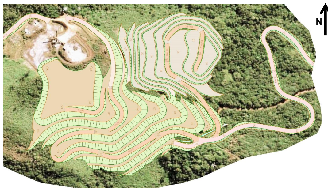
Figura 24 – Configuração Futura da Pilha de Estéril (Vista 02).
